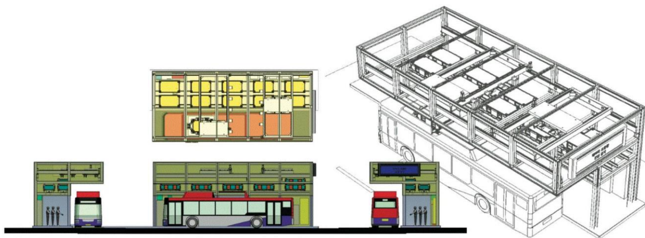
Рисунок В.2 – Схема автоматизированной станции с верхней заменой батарей.
